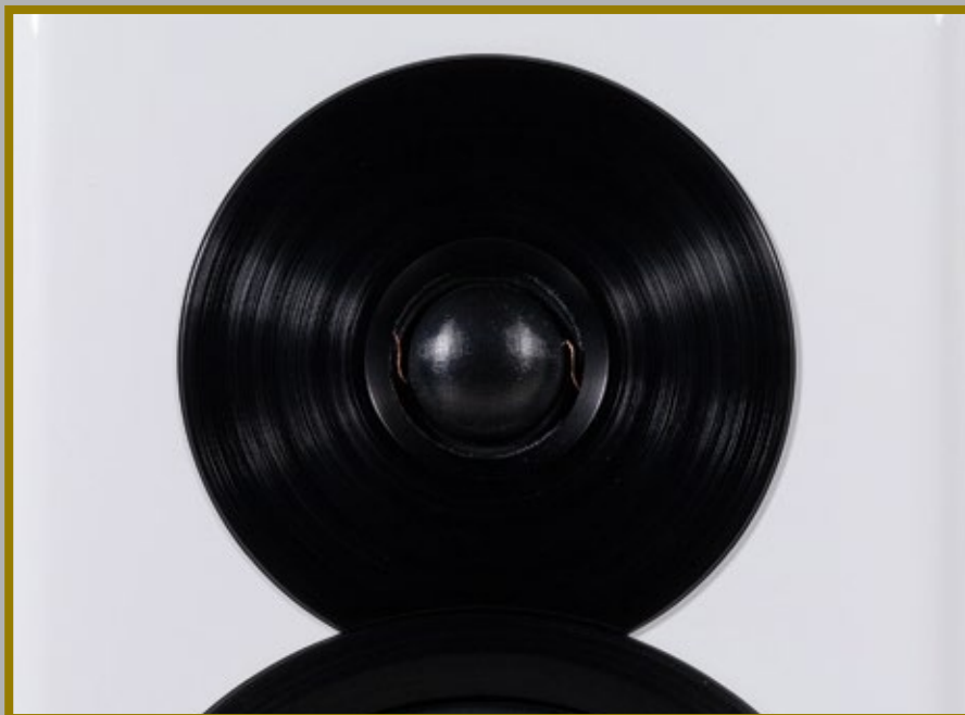
Der 2,8 Zentimetern messende Soft Dome Tweeter mit dem schönen Namen Cerotar setzt bei 2,2kHz ein und erreicht 36kHz bei -6 dB
