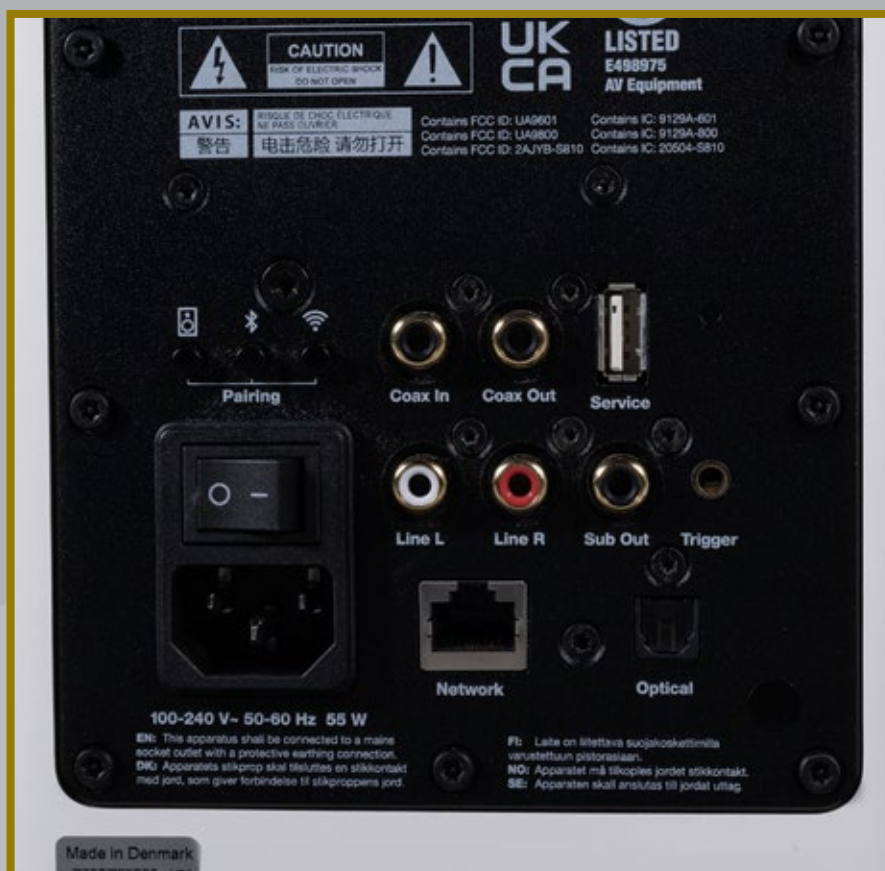
Am Master-Speaker der Dynaudio Focus 10 steht eine Reihe von digitalen und analogen Eingängen zur Verfügung. Natürlich verarbeiten die Lautsprecher auch alle kabellosen Dienste
